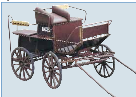
Art.0010. 4-hjuls maratholvogn. Det er plass til 4 personer og egner seg ypperlig for trening og turkjøring. Leveres med stålhjul og hydr. skivebrems på bakaksel.
