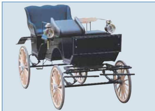
Art.0004. 6 seters Jaktvogn. Meget populær for bryllupskjøring og annen form for finkjøring. Leveres med gummibelagte trehjul, heleiptiske fjærer og hydr.skivebrems. Vognen er meget behagelig å kjøre. Leveres som enspenner og for parkjøring.
