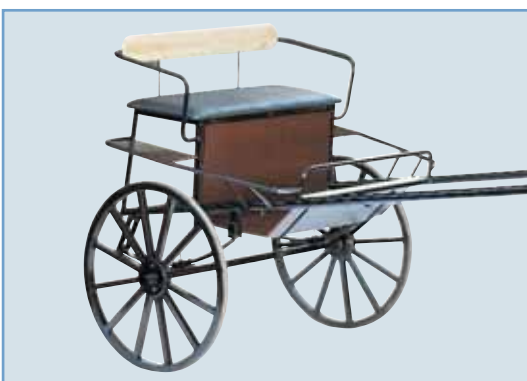
Art.0013C. Treningsgig. Leveres med trad. gummibelagte stålhjul og halveiptiske fjærer, fendere, skjerm, piskeholder og stigtrinn. Dette er en robust treningsgig med god avfjæring og god sittehøyde som gjør at du får god oversikt.
