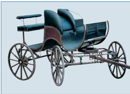
Art.0005. Elegant firehjuls presentasjonsvogn for enspenner og par. Vognen har hevdet seg godt i konkurranser både i Sverige og Norge. Vognen har gummibelagte trad.hjul i tre/stål. Og utstyrt med hydr.skivebrems bak.
